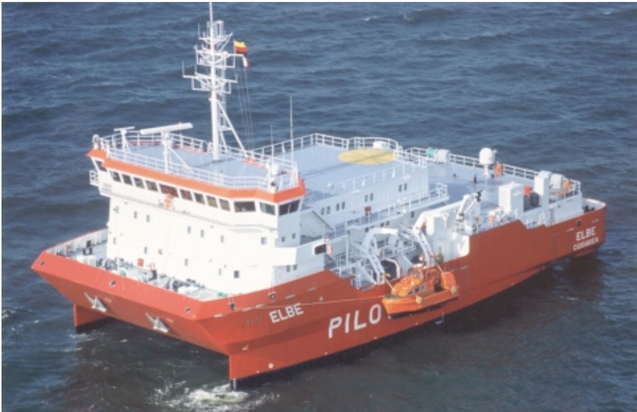
Nach dem SWATH-Prinzip gebautes Doppelrumpf-Lotsenstationsboot „Elbe“, 1.480 t Verdrängung
