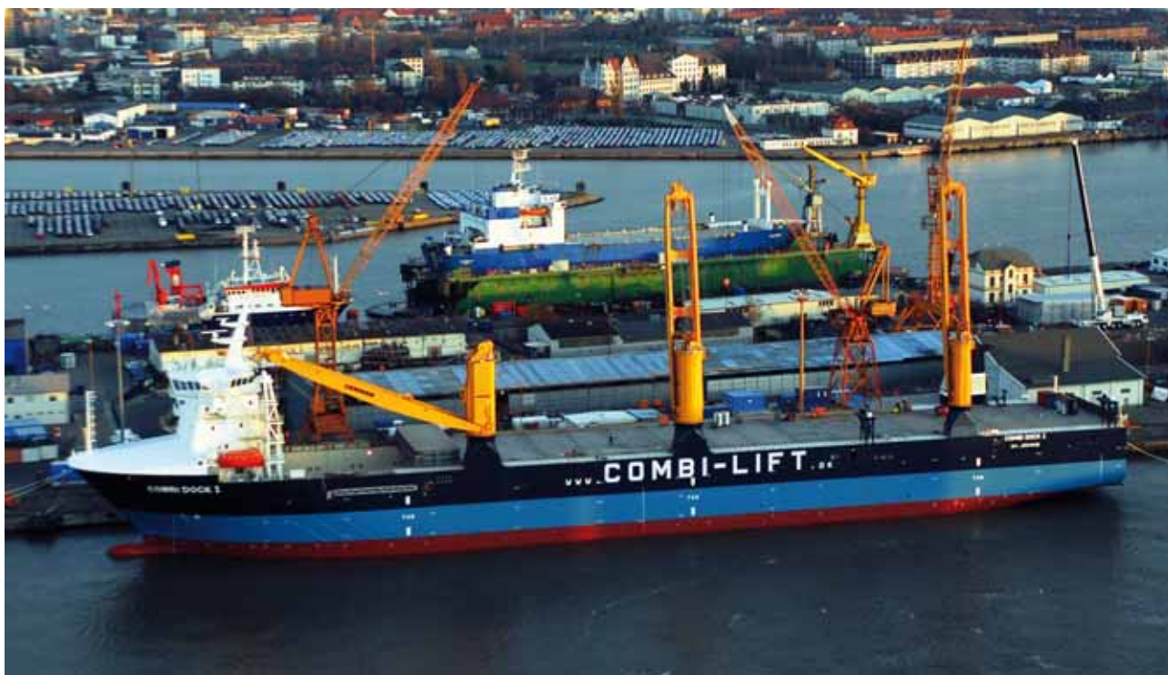
Dock- und RoRo-Speziialschiff „Combi Dock I“, Tragfähigkeit 11.000 TDW
