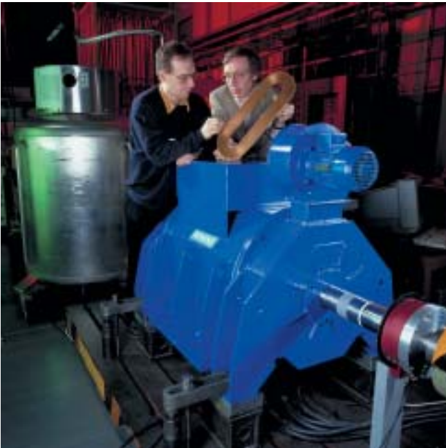
Europas erste Hoch-Temperatur-Supraleiter-Synchronmaschine zur Verbesserung der elektrischen Energieversorgung von Schiffen auf dem Teststand
