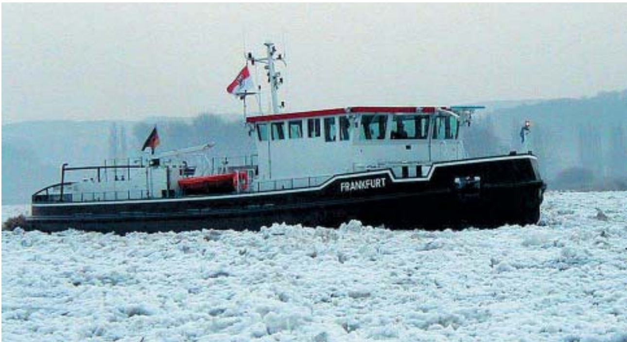
Flusseisbrecher „Frankfurt“ mit diesel-elektrischem Antrieb, installierte Gesamtleistung 1.064 kW
