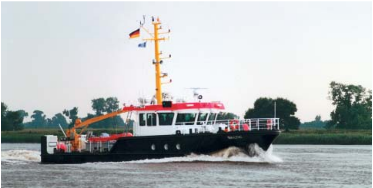
Peilschiff „Baltic“ für hydrographische Untersuchungen, 102 t Verdrängung
