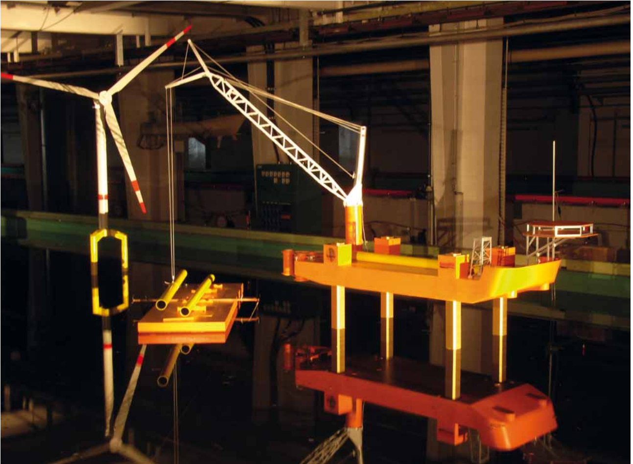
Modellversuch zur Errichtung einer Windkraftanlage
