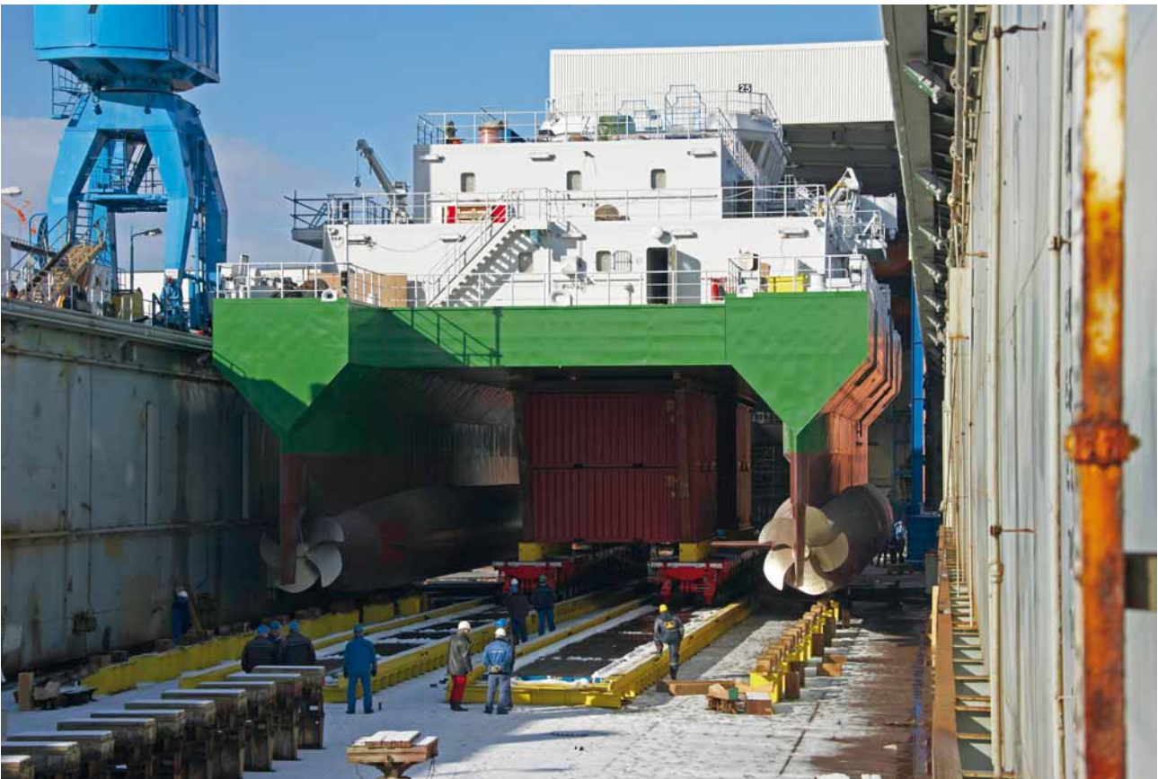
Bau eines SWATH-Zollbootes, 49 m Länge
