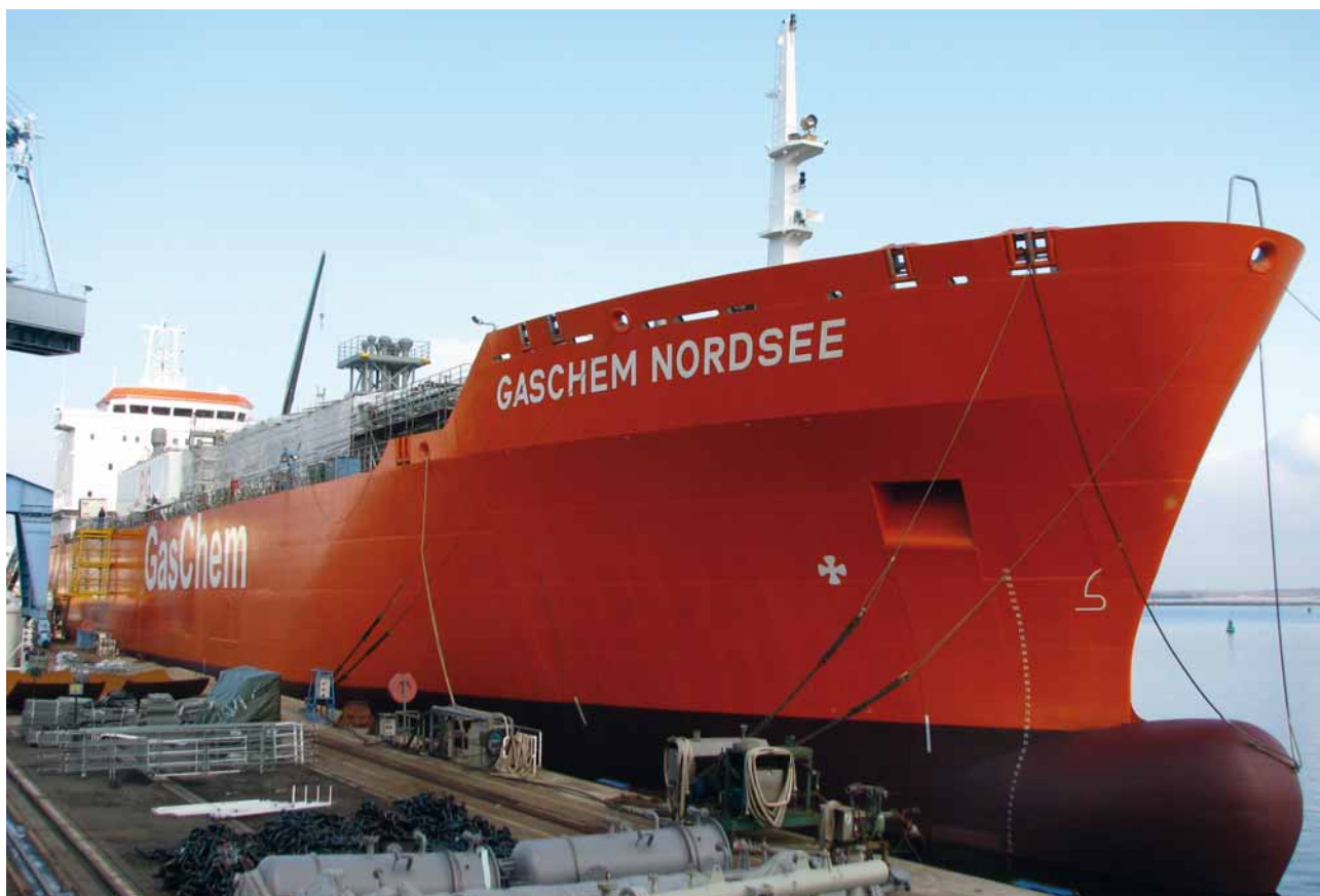
LPG/Ethylen Gastankschiff „GasChem Nordsee“, 17.000 m 3
