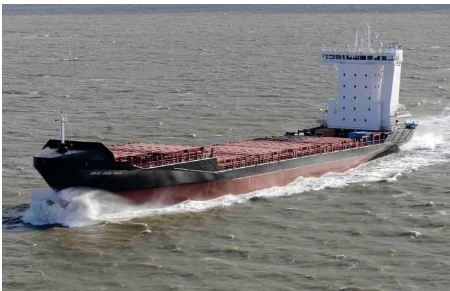
Feeder-Containerschiff „Ines Bolte“, 8.250 GT, 974 TEU
