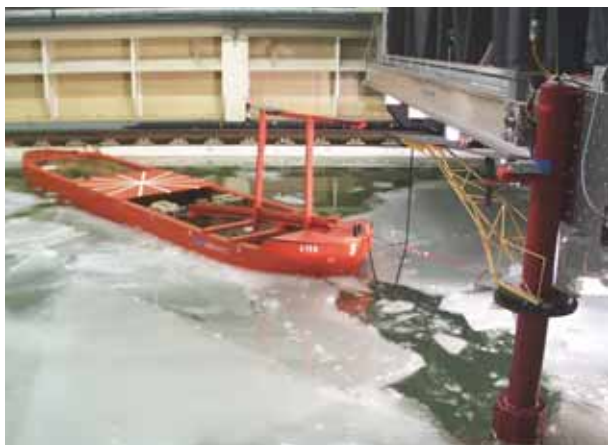
Modell eines eisgängigen Tankers im Eistank.
