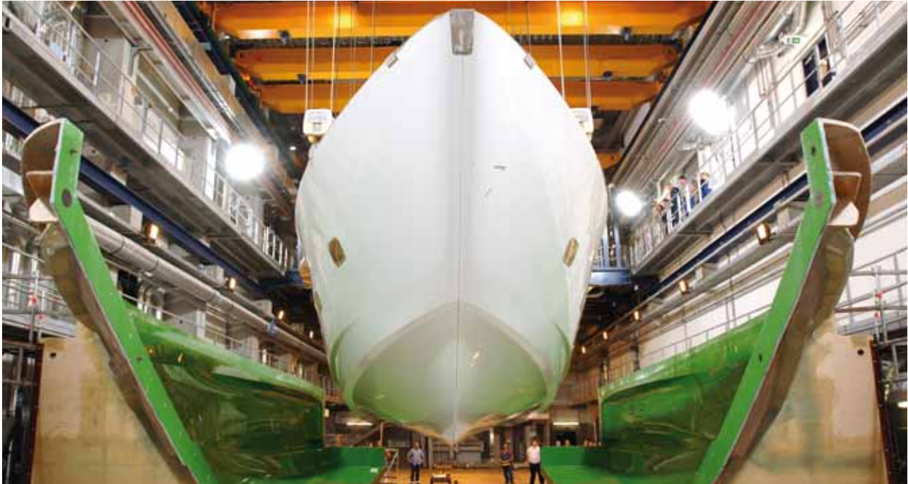
Fertigung eines Kunststoffumpfes des Yachttyps „Mazarin“, 24 m Länge
