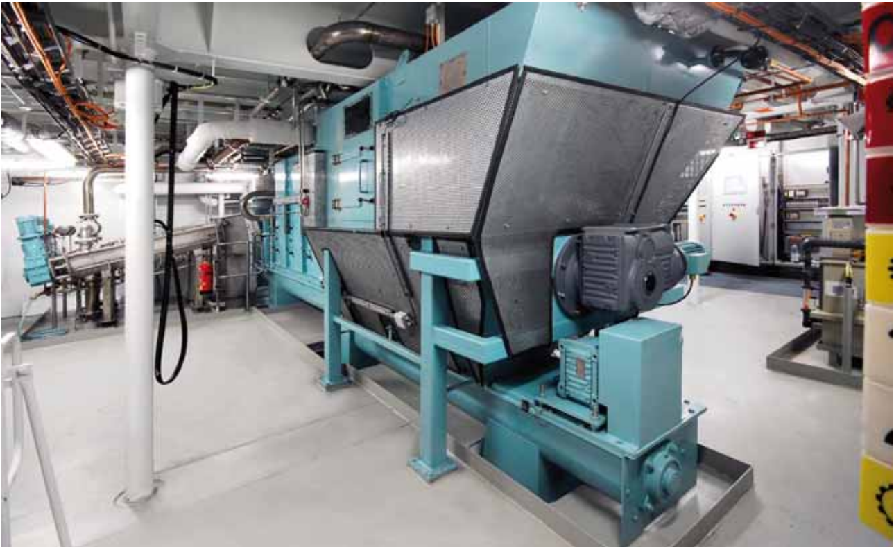
Abfalltank des Waste-Management-Systems auf einem Kreuzfahrtschiff
