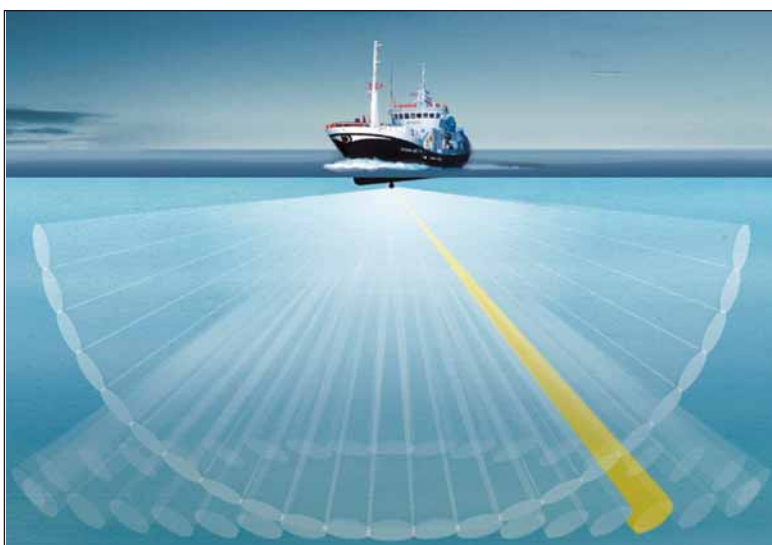
Fächerförmiges Echolot zur Meeresbodenerkundung
