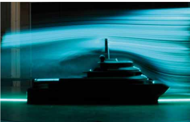
Windkanalversuch für neue Yacht in Swath-Bauweise
