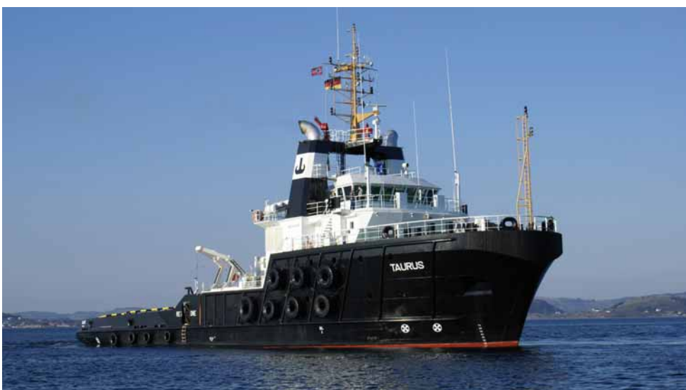
Hochseeschlepper „Taurus“ mit einem Pfahlzug von 200 Tonnen, 2.000 GT
